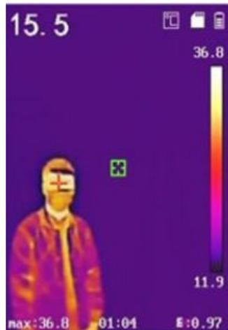
付属の三脚と組合わせて、自立させて利用可能です。解像度160×120の熱センサーで、目的物を正確に温度測定でき、発熱等の体温異常などを迅速に見つけることが可能です。microSDへ記録・保存が出来ます。
